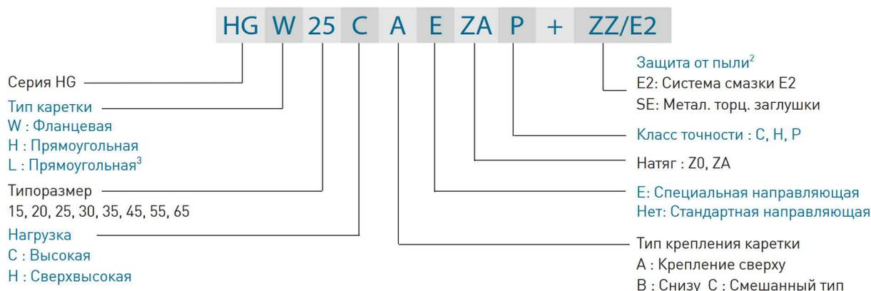
○ Маркировка направляющей серии HG
