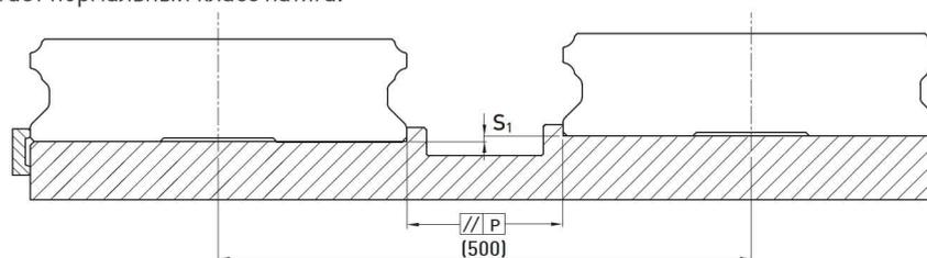
Табл. 2-5-14 Макс. допуск параллельности (P)
