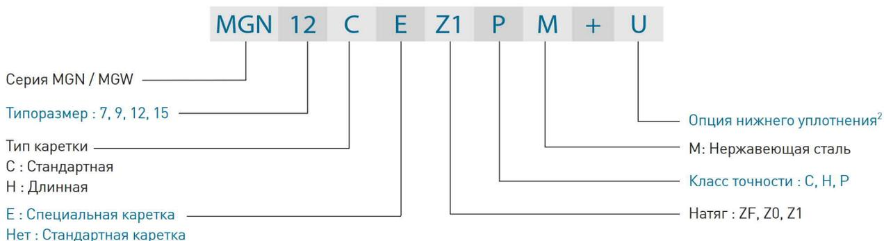
○ Маркировка направляющей серии MG
