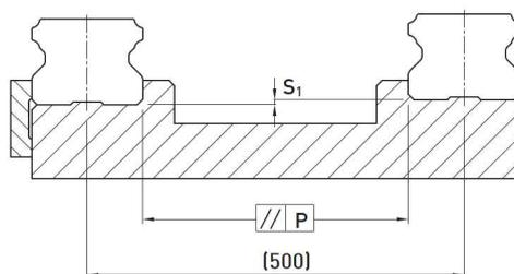
Табл. 2-2-16 Макс. допуск параллельности (P)
