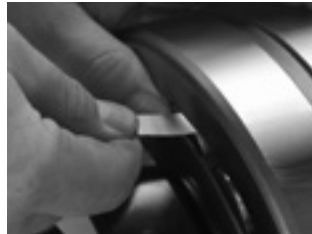
Рис. 14. Измерьте РВЗ до монтажа.
