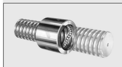
Рис 3.2 Внутренний тип рециркуляции шариков с обратным переходом
