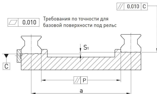
Табл. 2-7-22 Max. допуск параллельности (P)
