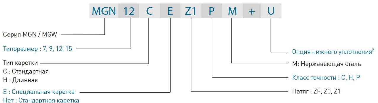
○ Маркировка направляющей серии MG
