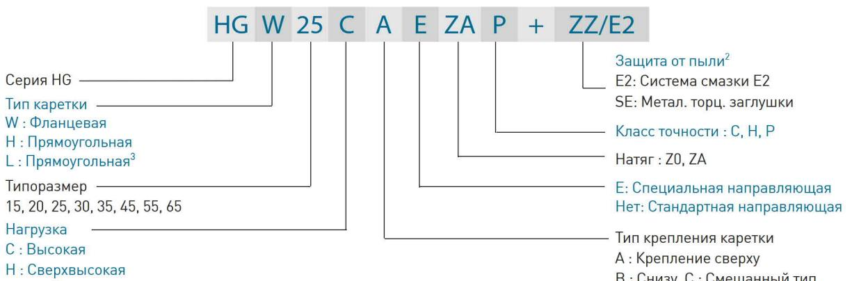
○ Маркировка направляющей серии HG
