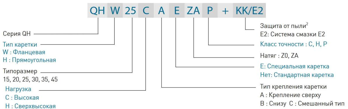
○ Маркировка рельса QH (серии QH и HG используют идентичный рельс)
