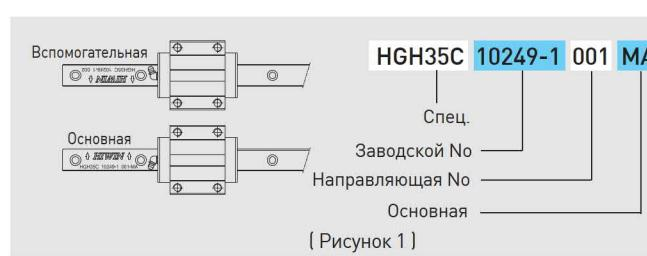
3. Определение базовой поверхности: базовая поверхность (B) направляющей это сторона, указанная стрелкой, которая промаркирована на верхней поверхности рельса. Базовая поверхность крепёжной - гладкая поверхность крепёжной, указанная как D на рисунке 2.
