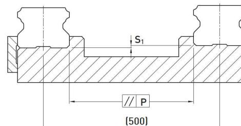
Табл. 2-2-16 Max. допуск параллельности (P)
