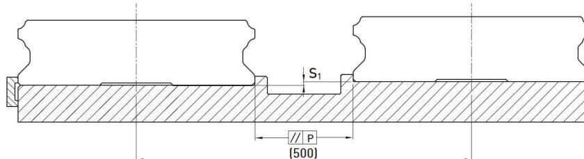
Табл. 2-5-14 Max. допуск параллельности (P)
