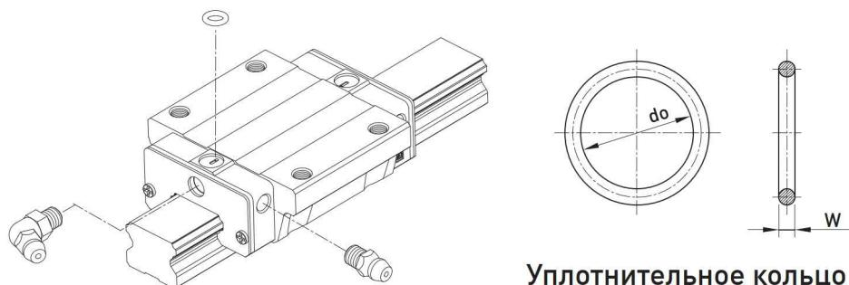
Табл. 2-2-9 Размер уплотнительного кольца и максимально допустимая глубина установки
