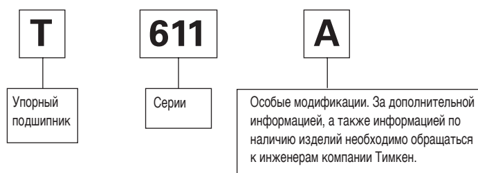
Рис. 41. Система обозначений упорных конических подшипников.
