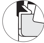
Рис. 1. Контакт широкого торца внутреннего кольца и упорного заплечика вала через посадочную часть уплотнения.
