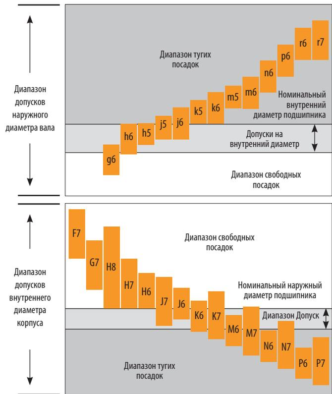
Рис. 5. Выбор посадки на вал и в корпус.
