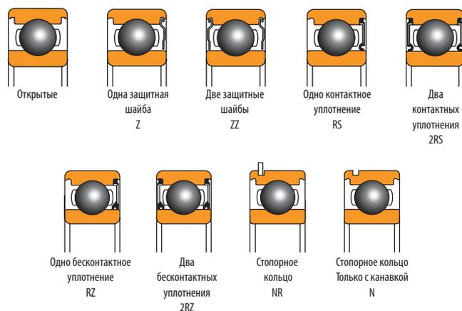
Рис. 4. Варианты исполнения шариковых подшипников с глубокой канавкой.
