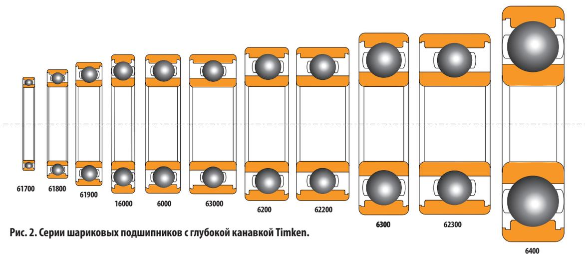
Рис. 2. Серии шариковых подшипников с глубокой канавкой Timken.
