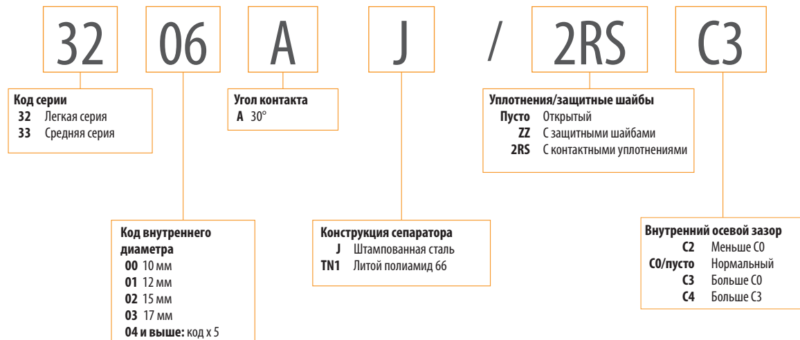
Рис. 18. Номенклатура двухрядных радиально-упорных шариковых подшипников.
